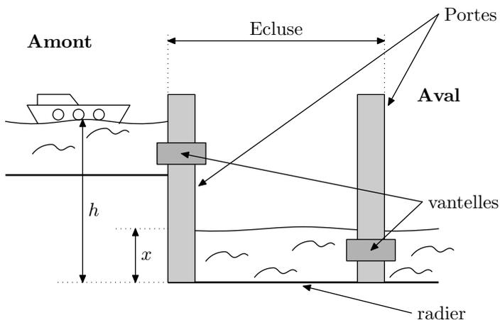
Toutes les mesures de longueur sont exprimés en mètres. On notera  $h$  la hauteur du niveau de l'eau en amont et  $x$  la hauteur du niveau de l'eau dans l'écluse. Ces hauteurs sont mesurées à partir du radier (*fond*) de l'écluse. (voir schéma ci-dessus). Lorsque la péniche se
