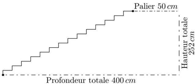
Un menuisier doit recouvrir ces marches de bois ; pour cela, il a besoin de connaître la longueur formée par les marches : cette longueur est représentée sur le dessin par la ligne brisée reliant les deux points.
